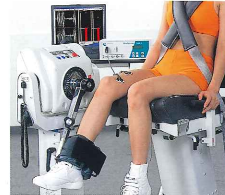
システム構成例 バイオデックスシステム3 BDX-3 シグナルアイソレーションユニット EM-IF 筋電計 マイオシステム EM-222 解析用パソコン EM-P3 マイオリザーXPマスター EM-129M
