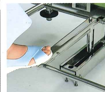
洗浄台を浴槽へ接近させたり、離したりする際にフットレバー操作によってロックの開閉を行います。
