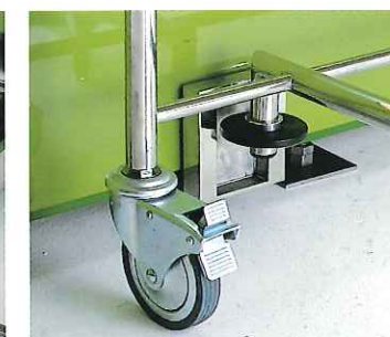
ストレッチャーを押しつけると自動的に円盤がリード溝にはまり、位置合わせが完了します。
